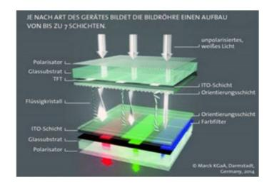
Je nach Art des Bildschirmes bestehen LCD-Geräte aus bis zu sieben Schichten.
